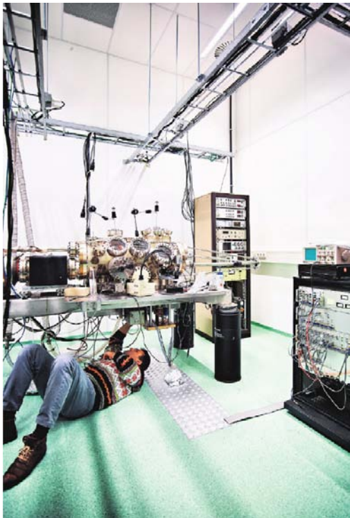
Figuur 3. Scanning tunneling microscoop bij ARCNL. Deze meetopstelling werd ontwikkeld bij de Universiteit Leiden door Dr. Marcel Rost en Dr. Vincent Fokkema en is speciaal bedoeld voor het afbeelden van atomaire oppervlakteprocessen, zoals aangroei en erosie. Preparaat en microscoop bevinden zich tijdens voorbereiding en waarneming in ultrahoog vacuüm. Aan het werk onder de microscoop is Dr. Amir Saedi, voormalig postdoctoraal onderzoeker bij ARCNL. Foto: Merlijn Doomernik ( www.doomernik.com )
